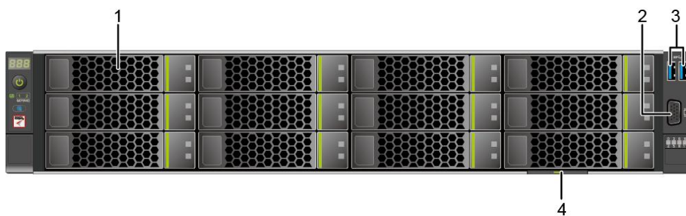
图 5-1 12x3.5 英寸硬盘配置前面板组件
